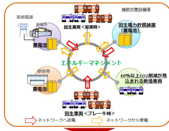
鉄道車両の回生電力を有効活用する設備や省エネ車両の導入により、鉄道システム全体の省CO<sub>2</sub>化を加速させ、鉄道分野において2030年度に2012年度基準で16.56%のCO<sub>2</sub>排出量削減を達成する
