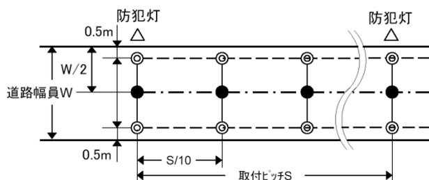
クラスA及びBの場合、道路中心線上の●印の位置で鉛直照度を測定する。
